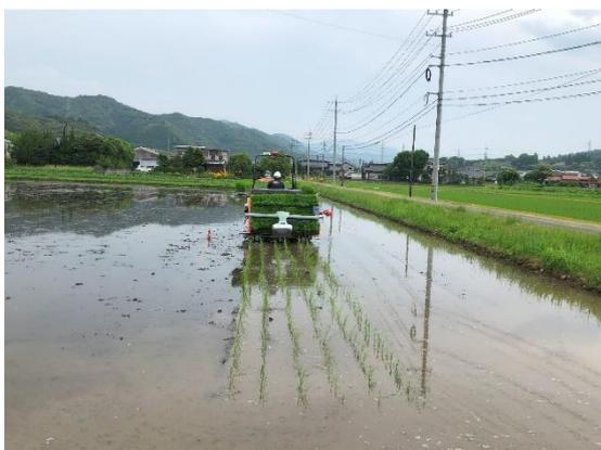
図 直進アシスト機能付き田植機による移植
